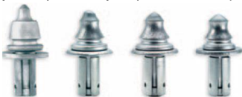
Рис. 1.1 Последовательность износа резца.
