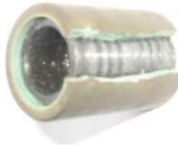
Рис. 3 Разрыв эластичного покрытия валика при диаметре игл 0,5 мм после 48 часов работы.
