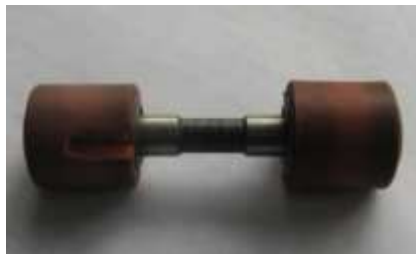
Рис. 3 Разрыв эластичного покрытия валика при диаметре игл 0,5 мм после 48 часов работы.
