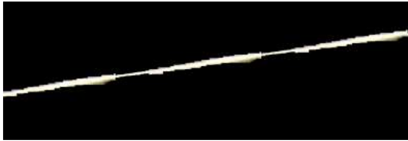
Рис. 6 Фасонная пряжа получена при использовании валика с лыской
