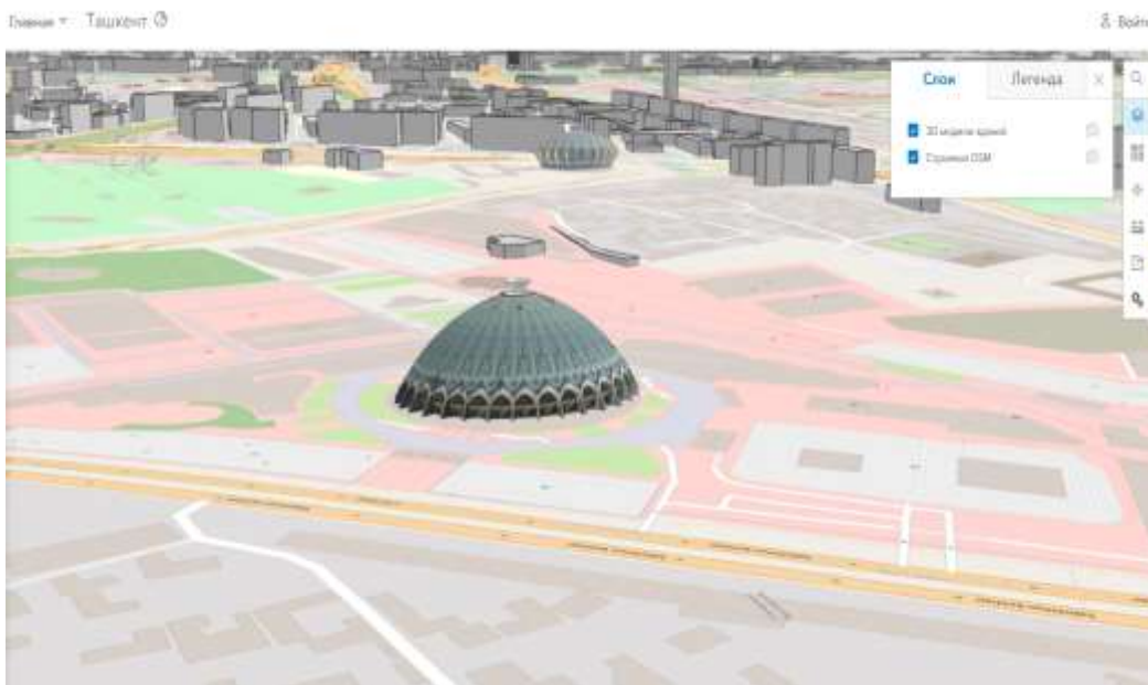
1-rasm. SketchUpda yaratilgan batafsil bino namunasi va 3D bloklar sifatida qo'shilgan OSM ma'lumotlari (binolar).
