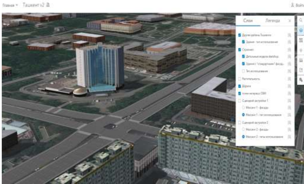
2-rasm. Binolar, "standart" fasadlar va yo'l qoplamalari ArcGIS City Engine yaratilgan va 3D sahnasiga qo'shilgan.
