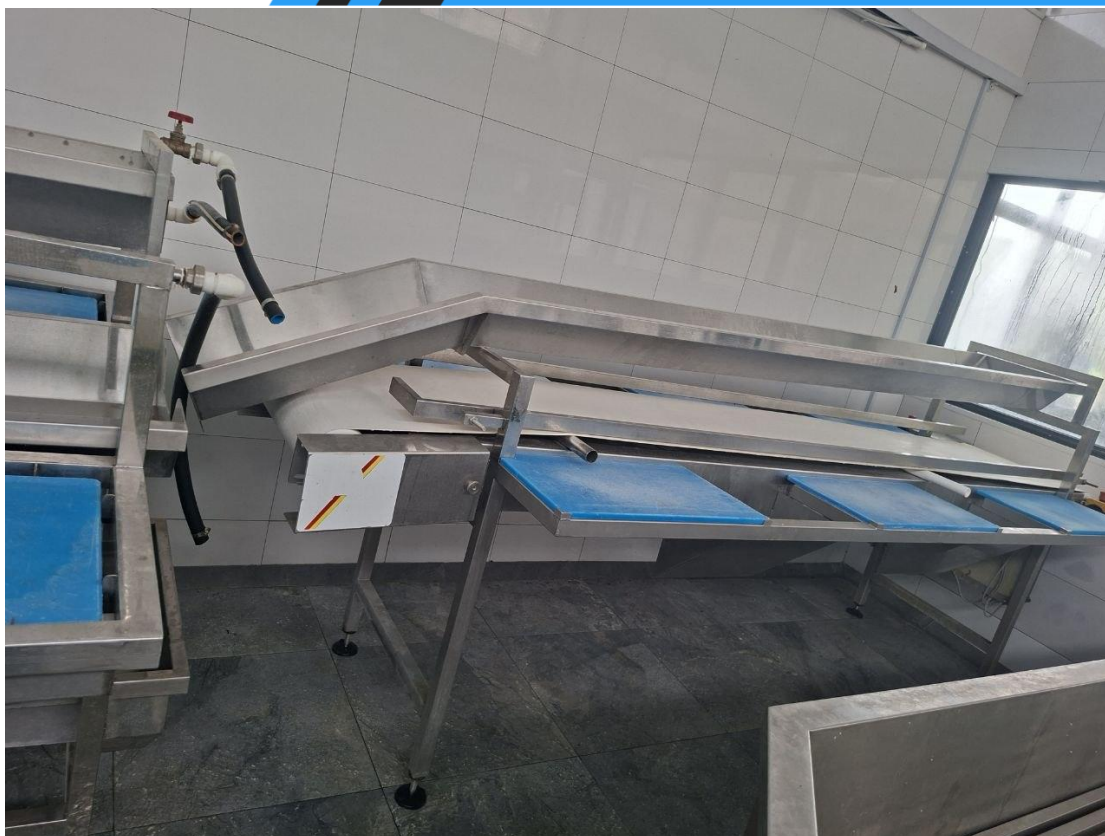
2-rasm. Ko'rinib turgan uzun V-shakldagi metall nov chiqindilarni yig'ish va chiqarish tizimi hisoblanadi.
