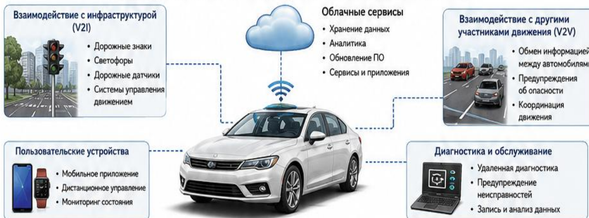
Рисунок 3 – Архитектура подключенного автомобиля (Connected Car)
