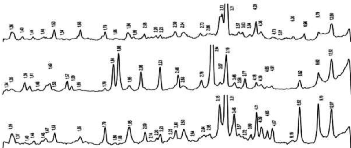
Рис.1. Рентгенофазный анализ показывает, что исследуемые образцы представлены полиминеральной смесью, состоящей из двуводного гипса, кварца и глинистых минералов.
