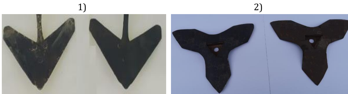
Yangi amalda ishlatilayotgan o'qyoysimon panjalar (1) va eksperimental (2) panjalar
