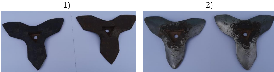
1) yangisi va 2) 86,5 ga maydonga ishlov bergandagi holati.
