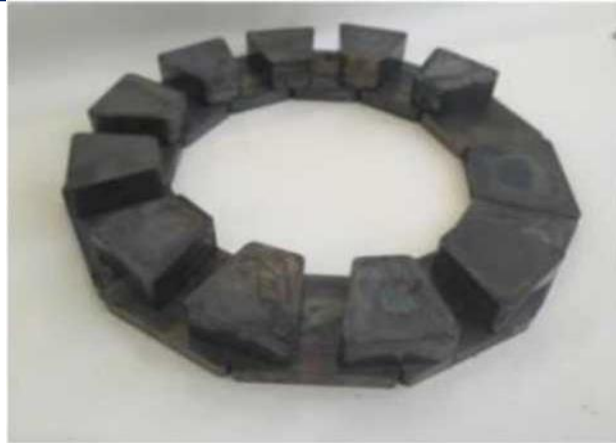
Рисунок 4: Статор прототипа двухстаторного электродвигателя с применением композитного магнитомягкого материала на основе ASCI 00.29
