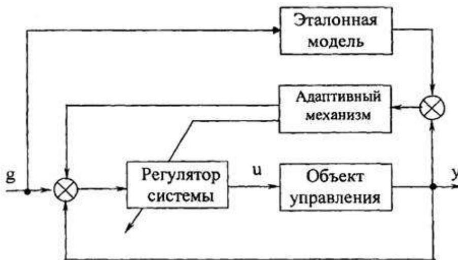
Рис. 4. Адаптивная система с параллельным включением эталонной модели.
