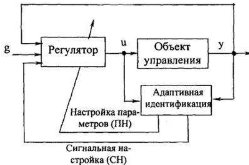
Рис. 2. Адаптивная система с параллельной настраиваемой моделью.
