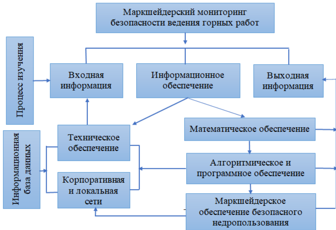
Рис.1. Блок-схема информационного обеспечения маркшейдерского мониторинга безопасного недропользования
