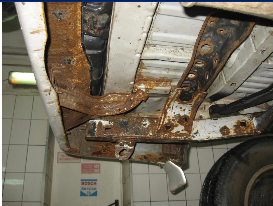
Рисунок 1 - Коррозия днища автомобиля
