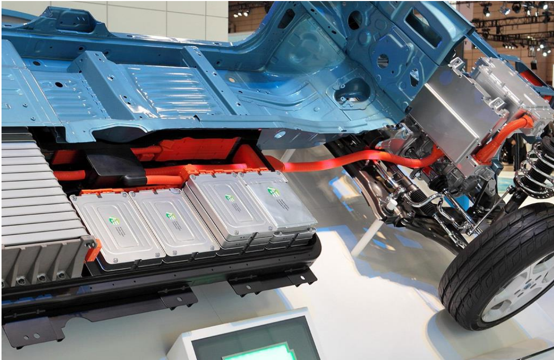
3-rasm. Elektromobil akkumulyatorlarning quvvat saqlovchi modullarining umumiy joylashuvi
