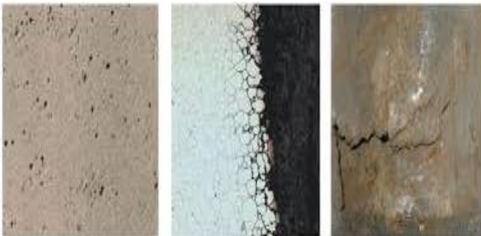
4 - Rasm. Pittingli korroziyaning rivojlanishi. a - nuqtalar ko'rinishida yuzaga kelishi, b - mikrostrukturada austenit strukturasi yeyilishi, v - korroziyaning rivojlanib uyiqlar hosil bo'lishi.
