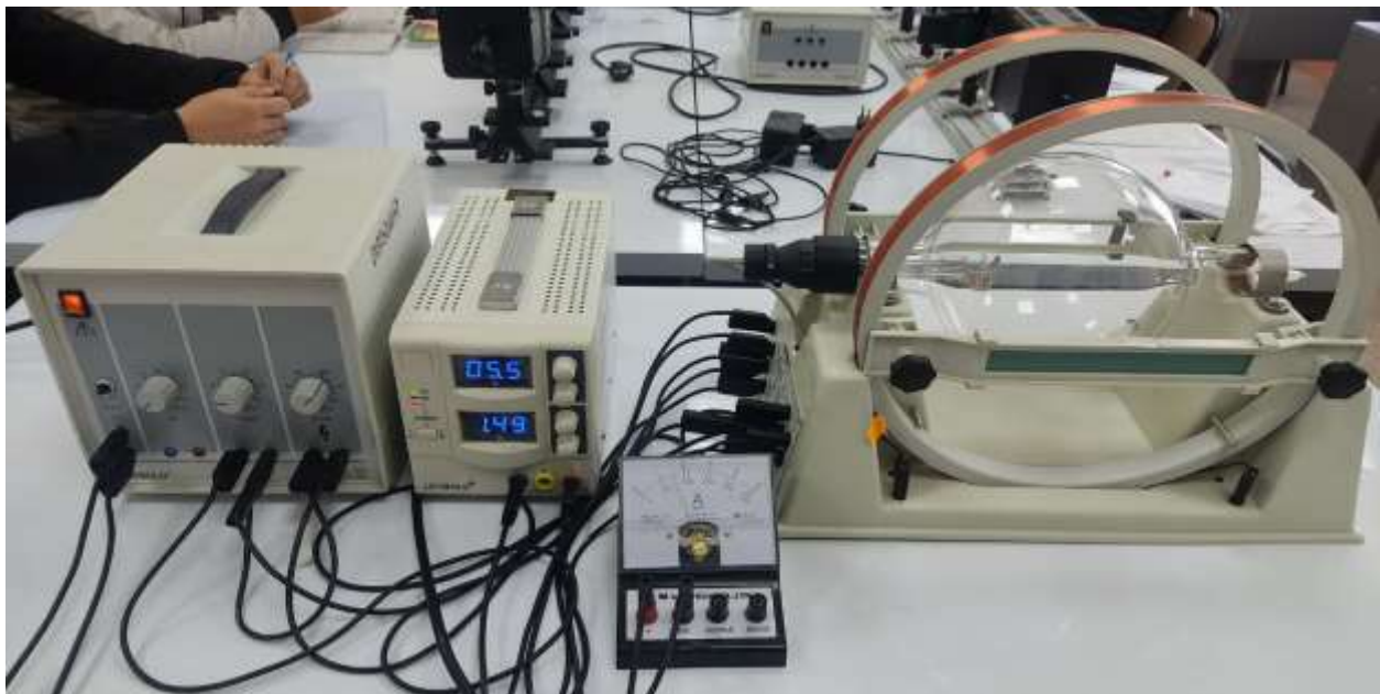
2-rasm: Elektronning solishtirma zaryadini aniqlash uchun tajriba qurilmasi
