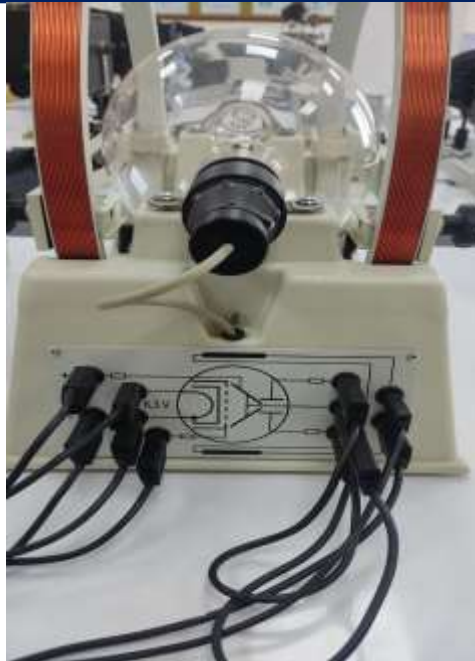
3-rasm: Elektrik ulash
