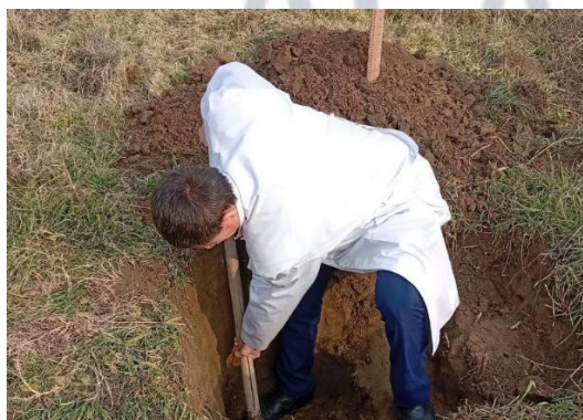
1-rasm. Tajriba dalasida tuproq namligi, qattiqligi va zichligini aniqlash uchun namunalar olish jarayoni.
