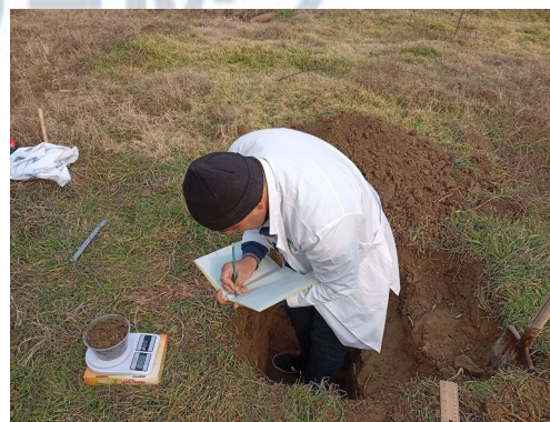
1-rasm. Tajriba dalasida tuproq namligi, qattiqligi va zichligini aniqlash uchun namunalar olish jarayoni.
