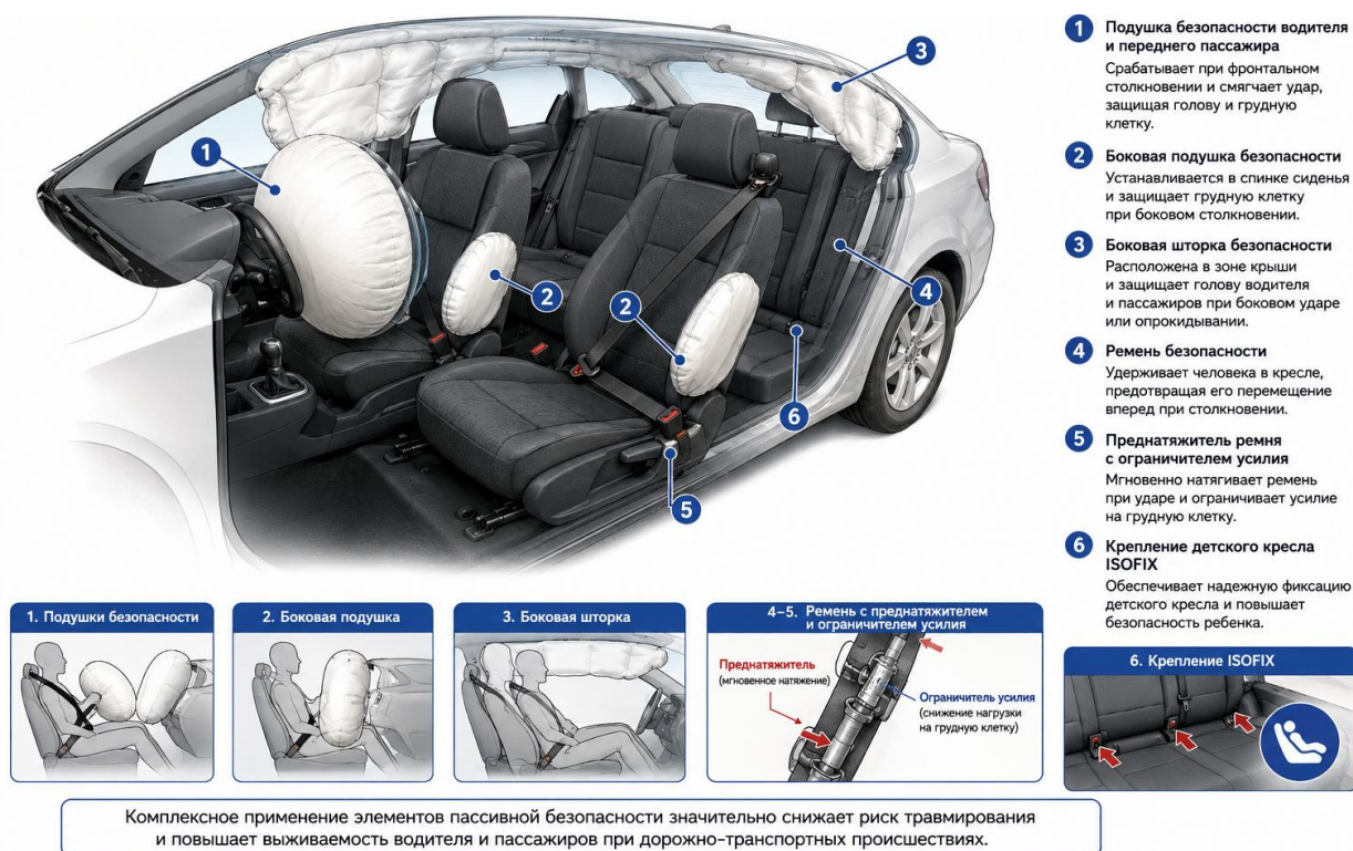
Рисунок 3 – Основные элементы пассивной безопасности автомобиля
