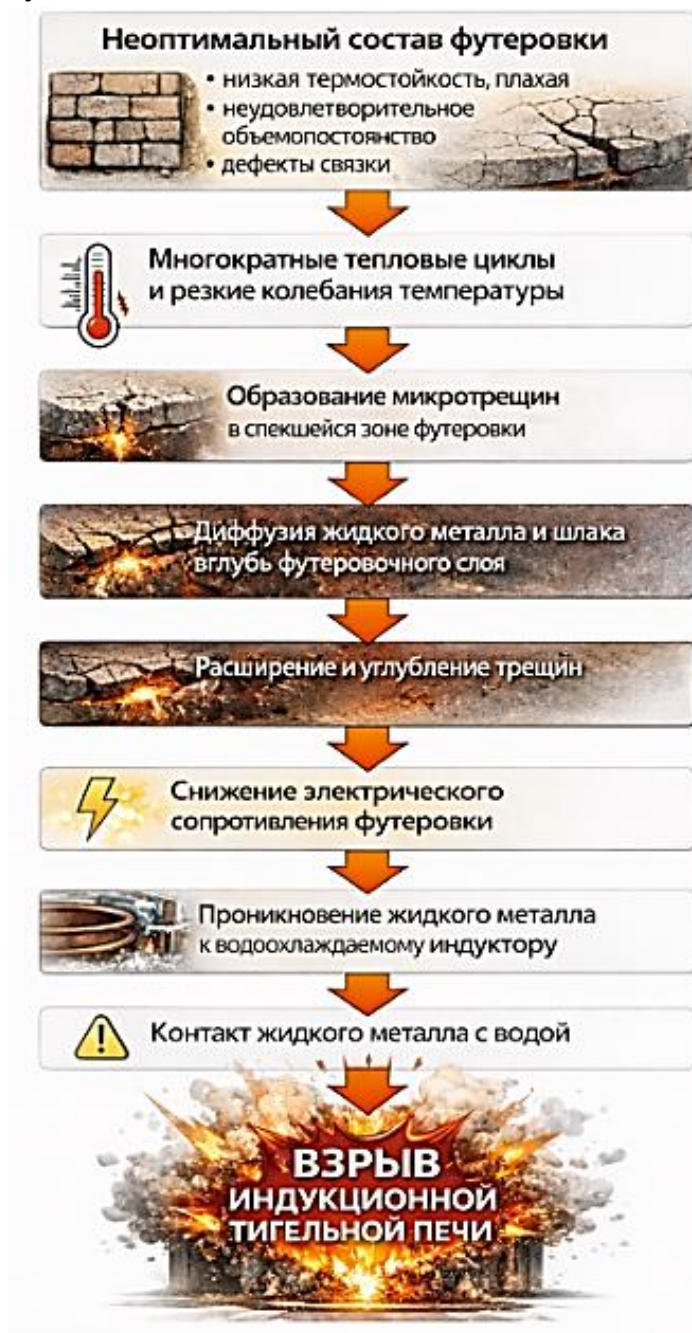
Рисунок 1 – Причинно-следственная схема влияния состояния футеровки на взрывоопасность индукционной тигельной печи
