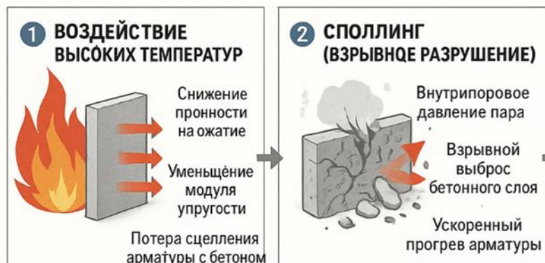
Рисунок 1. Огнестойкость монолитных конструкций при пожаре
