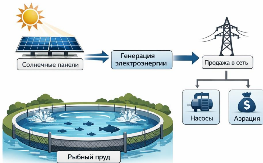
Рисунок 1 – Технологическая схема интеграции солнечной энергетики в рыбохозяйственную систему
