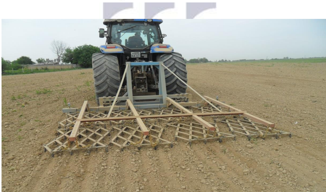
1-рама; 2- осийш қурилмаси; 3- изюмшаткич; 4- параллелограмм механизм; 5- тишли борона; 6- таянч чанғи
